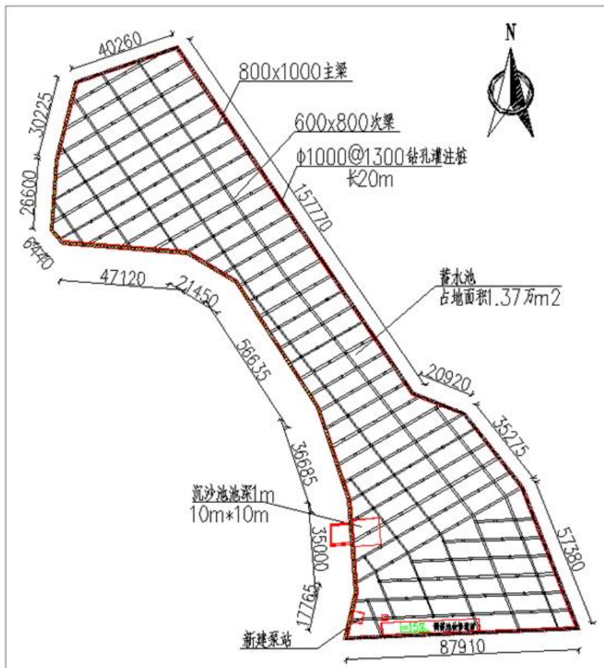
图 2.6-1 调蓄池结构平面图
