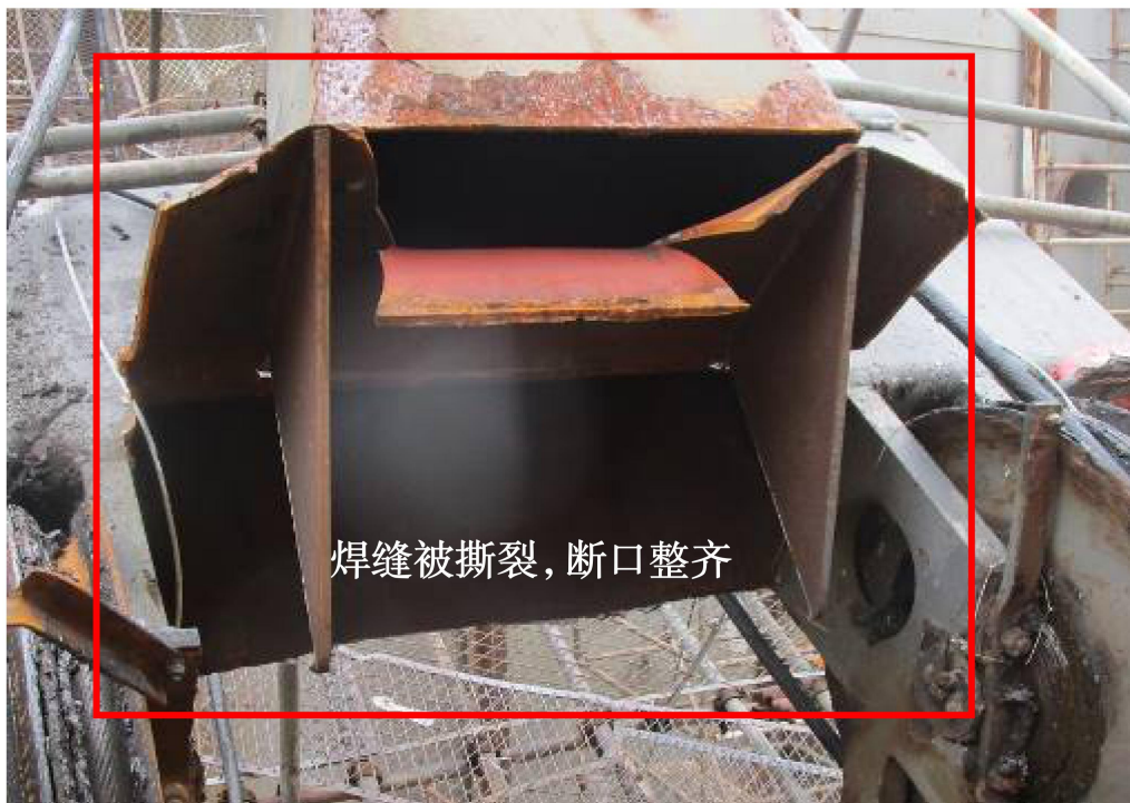
图 3：延伸臂连接处撕裂状态
