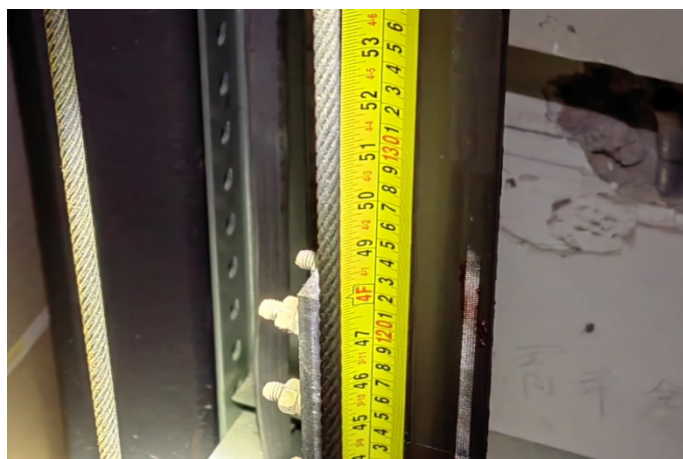
图 21 轿厢左侧轨道有 1.23m 的制停划痕
