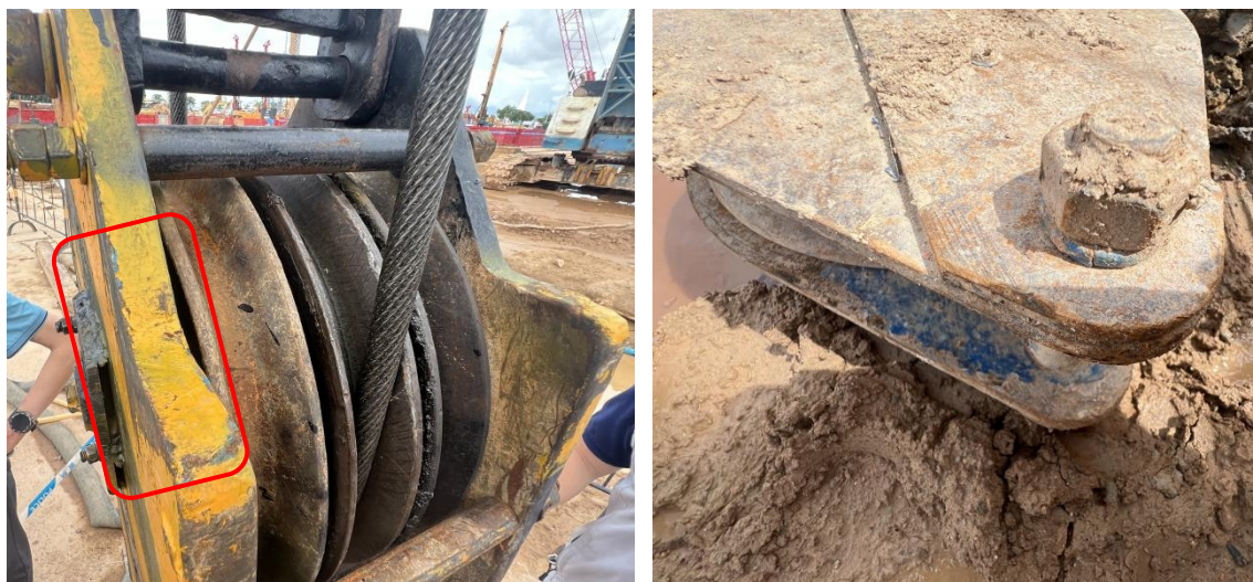
图 10 涉事履带吊滑轮表面碰撞痕迹
