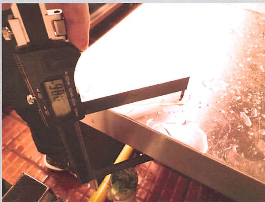
炉面拼台面板厚度
