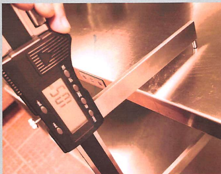
双通取餐柜(三层单边门)层板厚度
