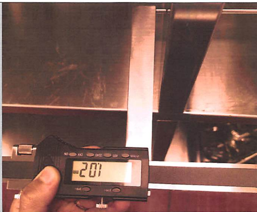
双通取餐柜(三层单边门)侧板厚度
