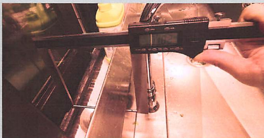
长条形不锈钢洗手池台面及池斗厚度
