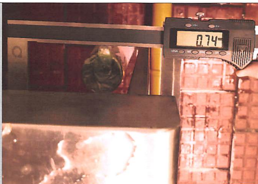
炉面拼台侧板厚度
