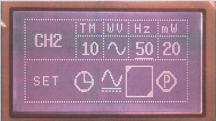
激光治疗仪输出时间、输出波形、输出频率、输出功率设置
