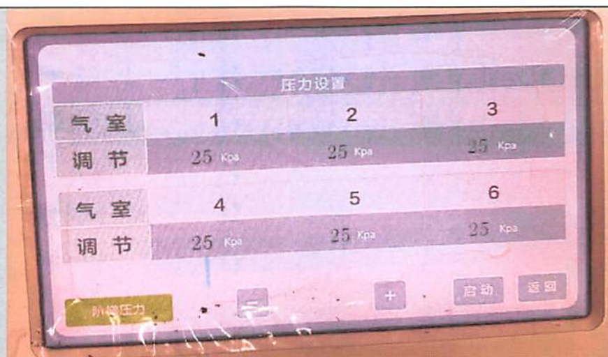
空气波压力治疗仪压力设置
